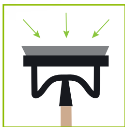
Lâmina em fita de serra de aço CK47 (resistente a impactos e a desgaste)
