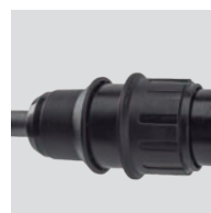
Réglage de la position du burin
