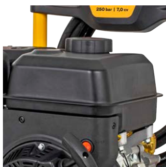
Réservoir de carburant Le moteur doit tourner avec un mélange d'essence 95 sans plomb. N'utilisez jamais d'essence contaminée ou un mélange d'huile et d'essence. Évitez les saletés ou de l'eau dans le réservoir. Pour vérifier le niveau de carburant et faire le plein, le moteur doit être arrêté.
