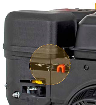
Lever d'accélérateur Le levier d'accélérateur permet de régler la vitesse de rotation du moteur de l'appareil.
