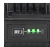
LED de estado de la batería
