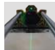
Láser y guías calibradas Ø20mm
