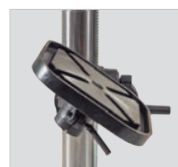
Inclinación de la mesa de trabajo hasta 45°
