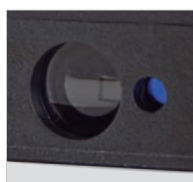
Lente de recepción y salida del rayo láser
