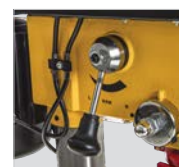
Variador de velocidad
