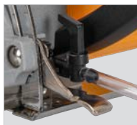
Refrigeración del disco con agua
