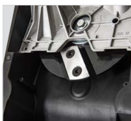
Lâminas em aço temperado
