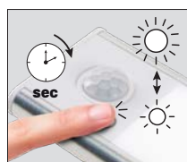
Fluxo luminoso: pressione prolongadamente o botão para aumentar/diminuir a luz
