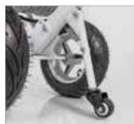
Roue arrière pour les changements de direction
