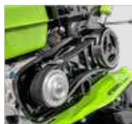
Double courroie de transmission
