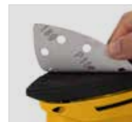
Fixação das lixas com velcro
